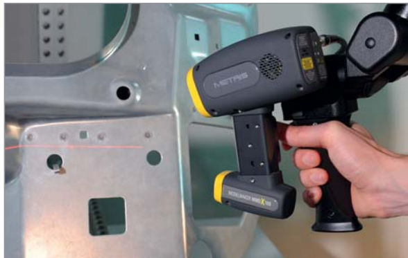
Цифровой сканер ModelMaker MMDx100
